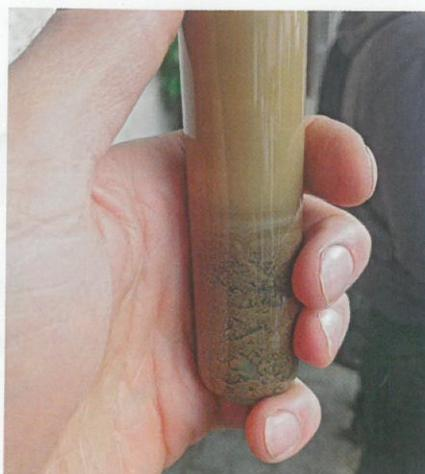
**Bodenprobe in destilliertem Wasser: Vor der Zugabe von Kalk braucht es mehr als 30 Minuten, bis sich die Erde im Wasser abgesetzt hat. Nach der Zugabe einer Messerspitze Kalk klärt sich das Wasser binnen weniger Augenblicke, da die Erde flockt und sedimentiert.**
